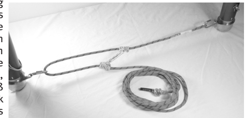
Abb. 14 Seilhobbelschleife mit Prusik. Genähte Schlaufe mit Schnellverbindungsglied verbunden. Große Schleife mit Schnellverbindungsglied des zweiten Beins verbunden.
