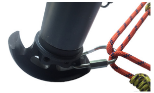
Abb. 13 Seilhoppelbefestigung mittels Schnellverbindungsglied
