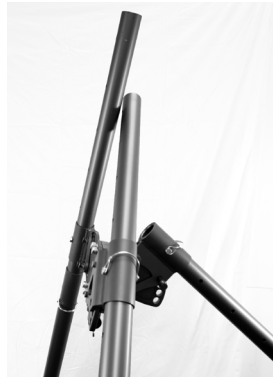
Abb. 8 Hinteres Bein mit zentrierter Beinklemme. Die Beine können aufgrund der Beinklemmenausrichtung aneinander vorbei reichen.
