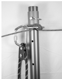
Abb. 25 Verzurr-Ring auf Rüstbaum (Gin Pole) als Hauptbefestigung
