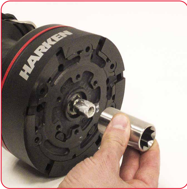
4. Den Kurbelersatz auf die Welle setzen.
