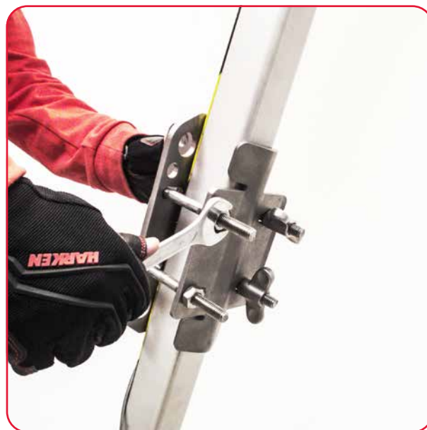
2. Die beiden Muttern mit einem Schraubenschlüssel anziehen (30 Nm).
