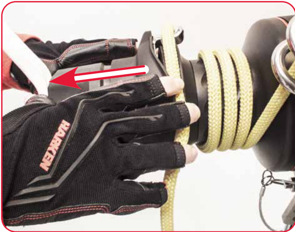
Die Beweglichkeit der Abdeckung der Umlenkrollenhälften prüfen.
