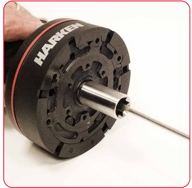
5. Die Schraube am Kurbelersatz anziehen.
